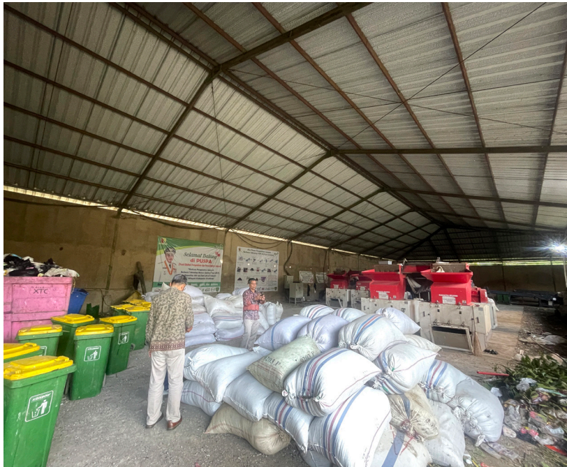
Pengolahan sampah di TPST Desa Jelekong yang memiliki unit Refuse Derived Fuel (RDF) untuk mengolah sampah menjadi bahan bakar
